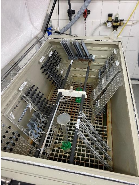
Ilustración 37 Prueba en cámara salina
